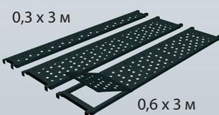
12. **Настил под кирпичную кладку** с габаритным размером 0,3 x 3 м выдерживает нагрузку до 400 кгс/м², поверх него устанавливаются деревянные щиты.
