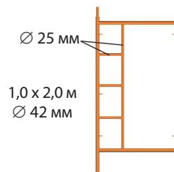
3. **Флажковое крепление** является неотъемлемой частью рамы, за счет которого выполняется крепление рам и связей строительных лесов. Правильное положение замка исключает самооткрывание.
