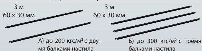
10. **Металлический каркас** с габаритным размером 1x3 м, обладающий повышенной прочностью по сравнению с легким настилом, укладывается на верхнюю перекладину рам, с нагрузкой до 250 кгс/м², поверх него устанавливаются деревянные щиты.
