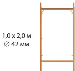
2. **Рама с лестницей** — элемент конструкции из стальных труб с флажковыми замками.
