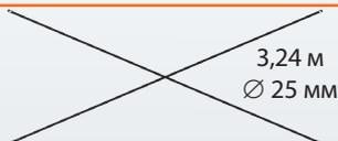
6. **Горизонтальная связь** — элемент конструкции служит для придания жесткости и ограждением в местах подъема на леса, также могут использоваться для ограждения рабочей зоны. Ø 25 мм, 3 м.
